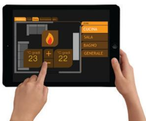
HG-BOX-LIGHT con Hi Vision può gestire tutta la tecnologia dell'abitazione e permette di navigare e interagire virtualmente con ogni funzione dell'impianto domotico. La grafica intuitiva e personalizzabile è arricchita da espressive icone animate, foto e planimetrie di sfondo, per supervisionare tutti i tipi di spazi con immediatezza.
